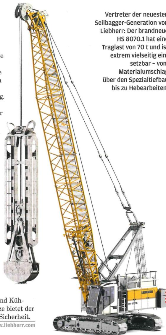
Vertreter der neuesten Seilbagger-Generation von Liebherr: Der brandneue HS 8070.1 hat eine Traglast von 70 t und ist extrem vielseitig einsetzbar - vom Materialumschlag über den Spezialtiefbau bis zu Hebearbeiten.
