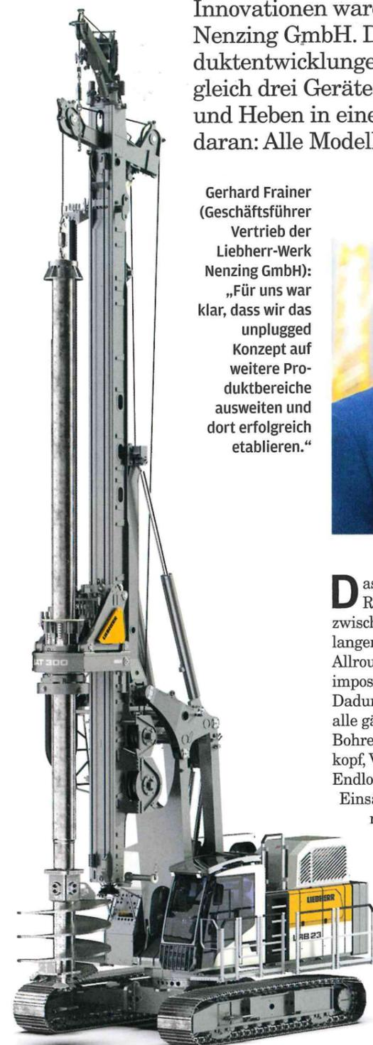
Mit dem LRB 23 präsentiert Liebherr ein kompaktes und transportfreundliches Ramm- und Bohrgerät. Es ist für alle gängigen Spezialtiefbaueinsätze geeignet, sogar Kellybohren ist möglich.
