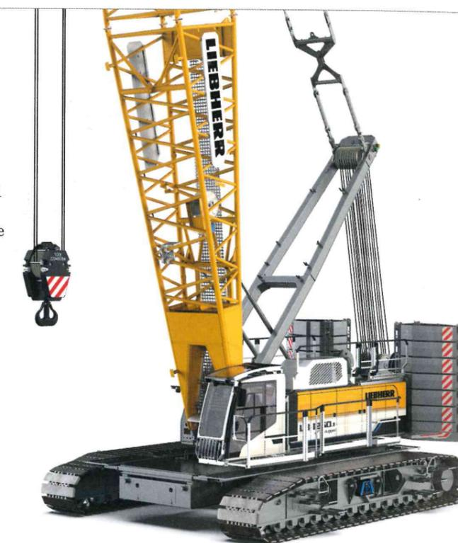
Als erste batteriebetriebene Raupenkrane der Welt werden der LR 1200.1 unplugged und der LR 1250.1 unplugged von Elektromotoren mit einer Systemleistung von 255 kW angetrieben. Sie sind ebenso leistungsfähig, wie die konventionelle Version.
